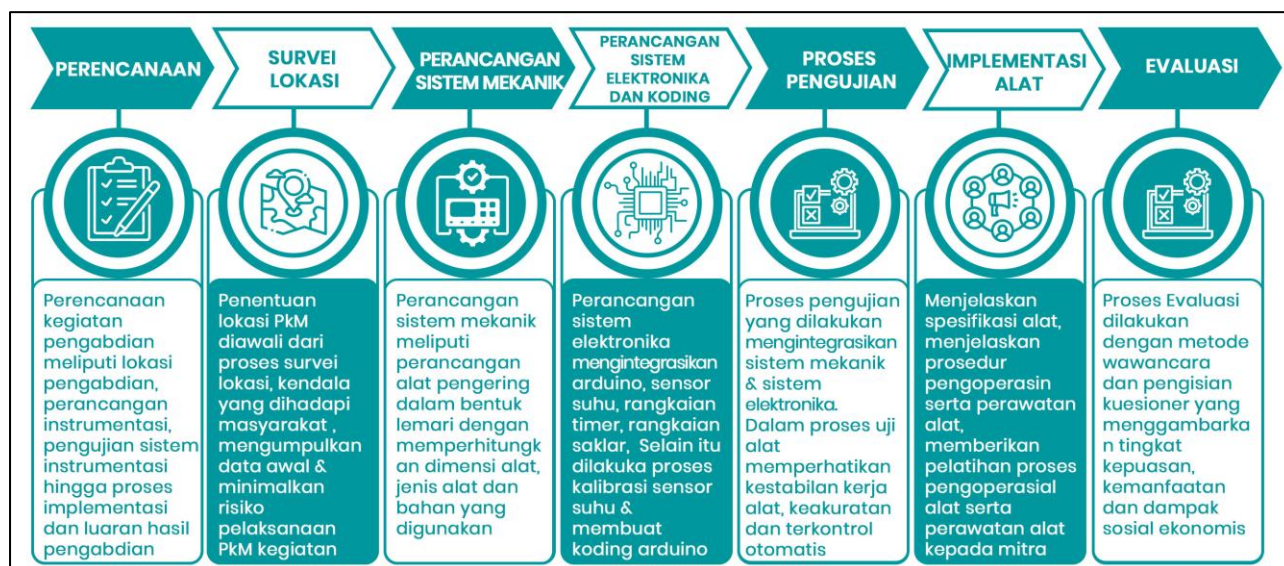
Gambar 2. Diagram proses perancangan hingga implementasi alat pengering pati sagu
