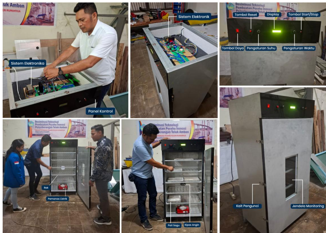
Gambar 7. Proses integrasi sistem mekanika, sistem elektronika dan proses pengujian alat
