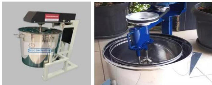
Gambar 5. Mesin pengaduk olahan rumput laut dan mixer pembuat adonan
