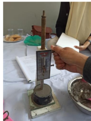
Gambar 2. Sampel fly ash dari berbagai sumber (kiri) dan Pengujian water requirement dengan alat Vicat (kanan)
