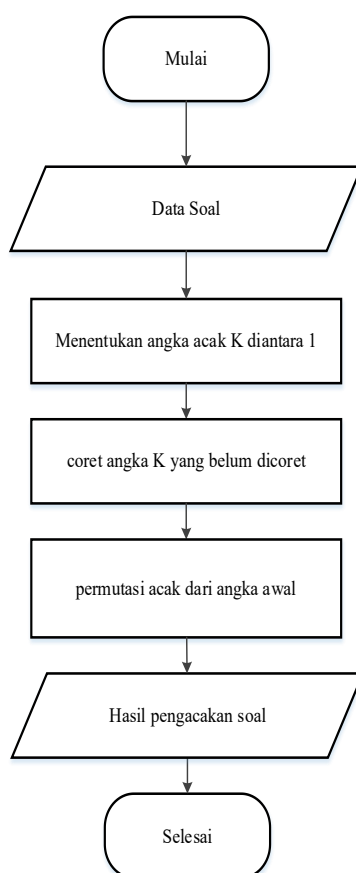
Gambar 2. Flowchart Dari Metode Fisher Yates Shuffle
