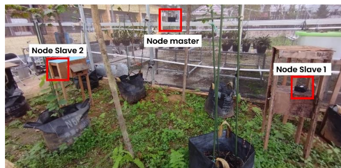
Gambar 8. Implementasi Sistem Komunikasi Antara Node Slave dan Node Master Menggunakan Algoritma Change Detection
