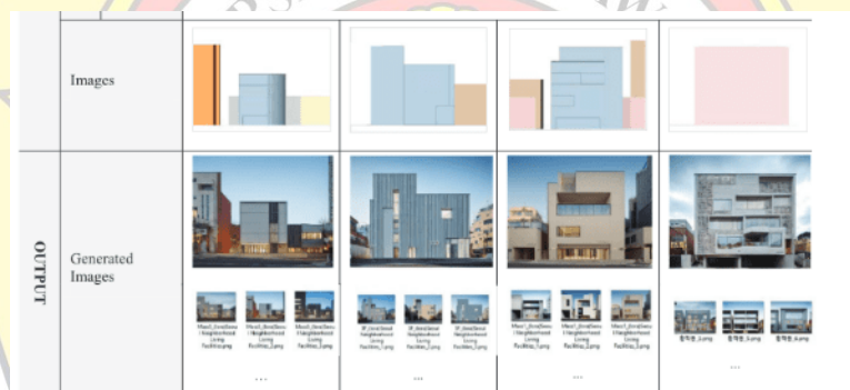
Gambar 10 Hasil visual rendering berbasis diffusion untuk menghasilkan gambar fotorealistik dari fasad bangunan
